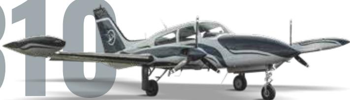
Avion six places servant pour les qualifications sur avion multimoteur, les vols nolisés et l'aéropointage pour la SOPFEU. Équipé de double commande et de deux moteurs 6 cylindres de 285 Hp chacun, sa vitesse de croisière est de 170 kts, sa consommation est d'environ 110 litres d'essence 100LL à l'heure et son autonomie est de 5 heures.
