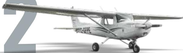
Avion deux places servant essentiellement pour les cours de pilotage privé (PPL) et professionnel (CPL). Équipé de double commande et d'un moteur 4 cylindres de 110 Hp, sa vitesse de croisière est de 95 kts, sa consommation est d'environ 24 litres d'essence 100LL à l'heure et son autonomie est de 4 heures.
