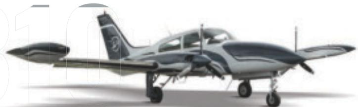
Avion six places servant pour les qualifications sur avion multimoteur, les vols nolisés et l'aéropointage pour la SOPFEU. Équipé de double commande et de deux moteurs 6 cylindres de 285 Hp chacun, sa vitesse de croisière est de 170 kts, sa consommation est d'environ 110 litres d'essence 100LL à l'heure et son autonomie est de 5 heures.
